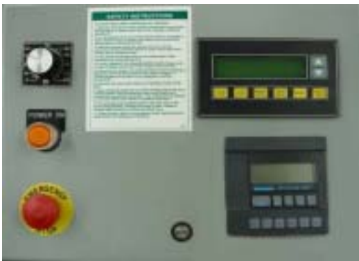
Panel del Operador de la A301 – LCD y mandos sencillos
