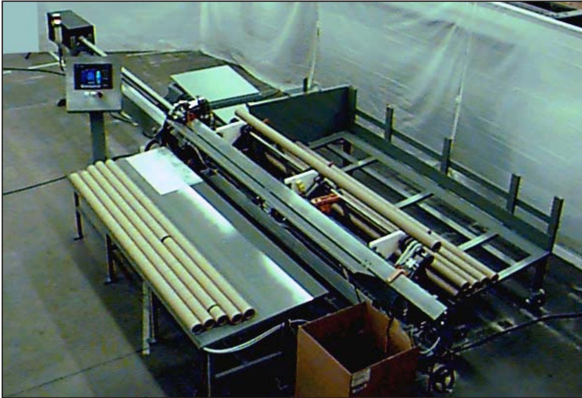
Cortadora de Tubetes P510 con Cargador Automático, Tolva, Elevador y Mesa Acumuladora con Desviador.
