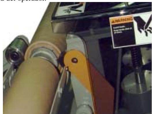
La cuchilla fija corta limpiamente los tubetes
